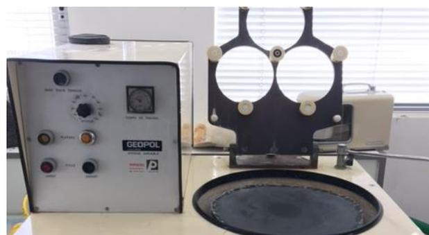
**Figure 2-10 : Machine de polissage GEOPOL (PRESI, Eybens, France).**
