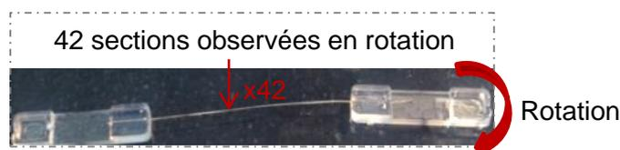
Figure 4-7: Représentation de la technique de mesure des dimensions transversales apparentes pour chaque rotation de  $360^\circ$  au FDAS.
