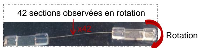
Figure 4-7: Représentation de la technique de mesure des dimensions transversales apparentes pour chaque rotation de 360° au FDAS.
