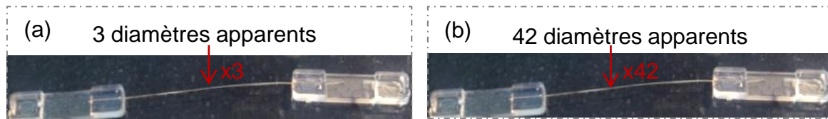
Figure 4-6: Représentation des deux techniques de mesure des dimensions transversales apparentes au FDAS sans rotation du faisceau de fibres.
