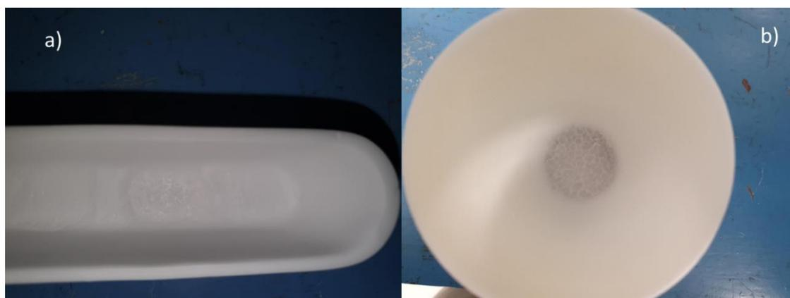
Figure 112 : photo d'un creuset abîmé par la corrosion du fluor a) de type bateau b) type classique
