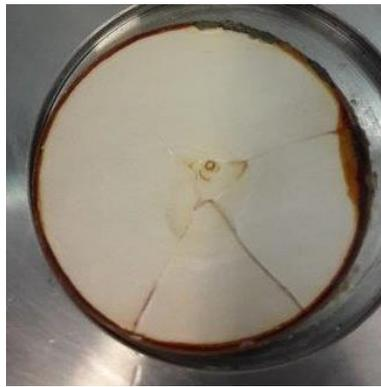
Figure 94 : céramique piézoélectrique fendue
