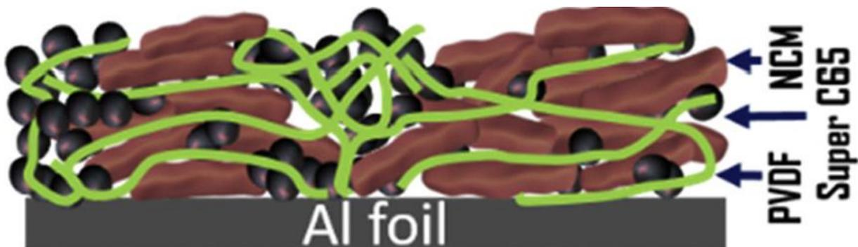
Figure 7 : schéma d'un exemple de formulation d'électrode [18]
