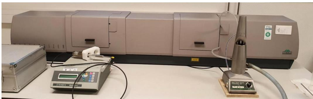
Figure 39 : granulomètre laser
