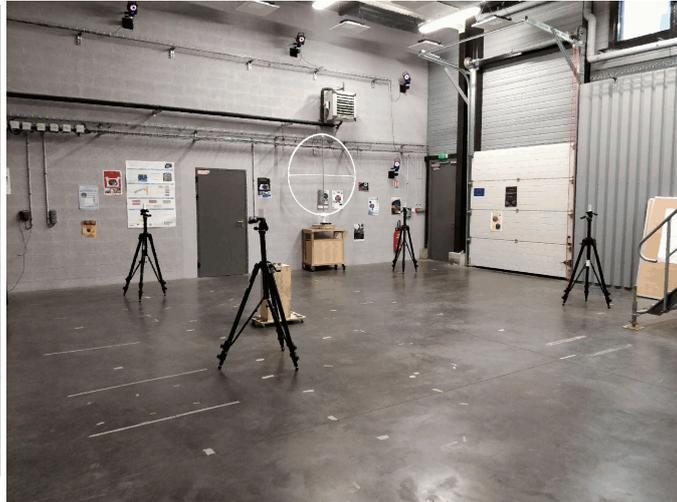
c Placement des ancrages dans le laboratoire.
