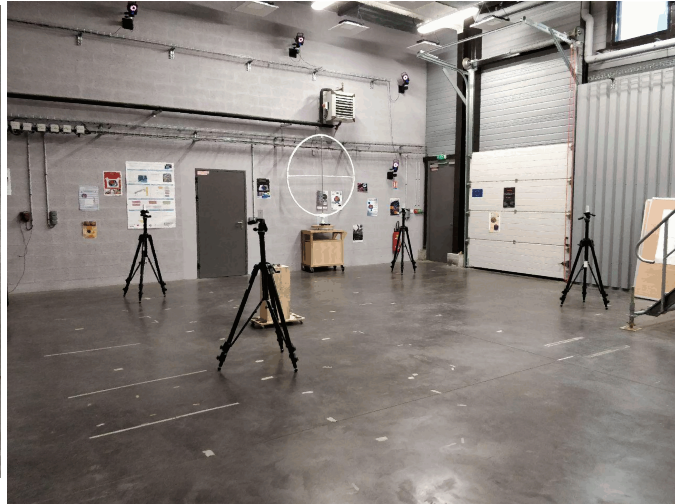
c Placement des ancrs dans le laboratoire.
