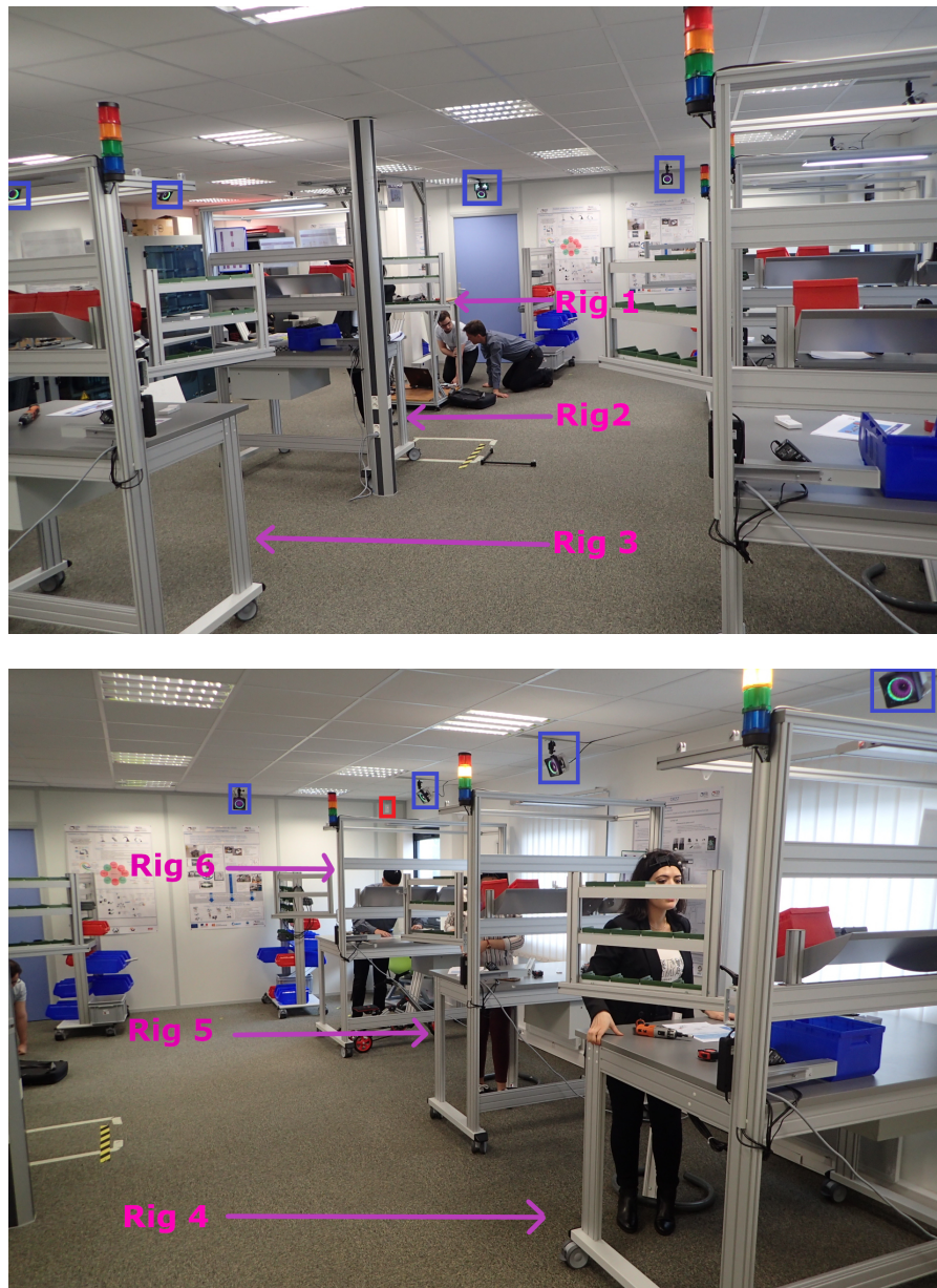
FIGURE 3.2 – Notre système UWB est installé dans une chaîne de montage industrielle NLDV. Dans les carrés bleus se trouve le système MoCap et dans le carré rouge le système UWB lorsqu'il n'est pas caché en raison des conditions NLDV. Installation industrielle dans une zone non visible (NLDV) avec six installations de montage. vue [A]. (b) Installation industrielle en NLDV avec six postes de montage. vue [B].
