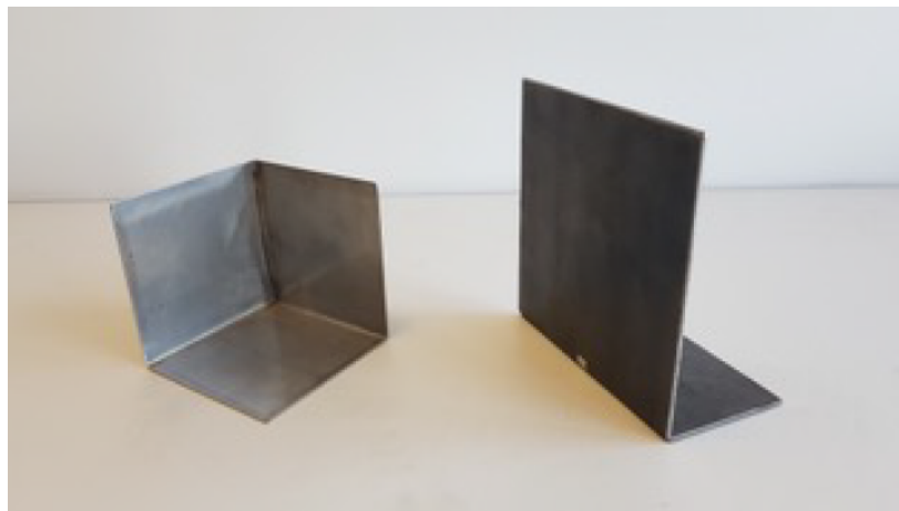
FIGURE 3.20 – Photo du trièdre métallique de 100 mm \times 100 mm \times 100 mm (à gauche) et de la plaque métallique de 148 mm \times 151 mm (à droite).
