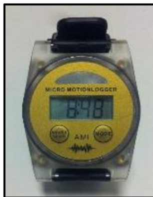
Figure 16. La montre-bracelet à marqueurs d'évènements Micro MotionLogger
