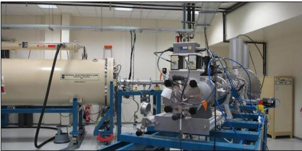
**Figure III. 8 :** Spectromètre de masse couplé à un accélérateur : « ARTEMIS »
