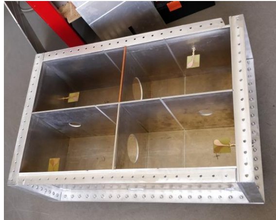
Figure 43 : Configuration des ouvertures dans la maquette : cas 5 cavités
