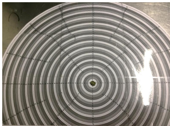
Figure 42. Photo du dispositif de mesure de la distance de saut au stade crapelet. © L. Lange
