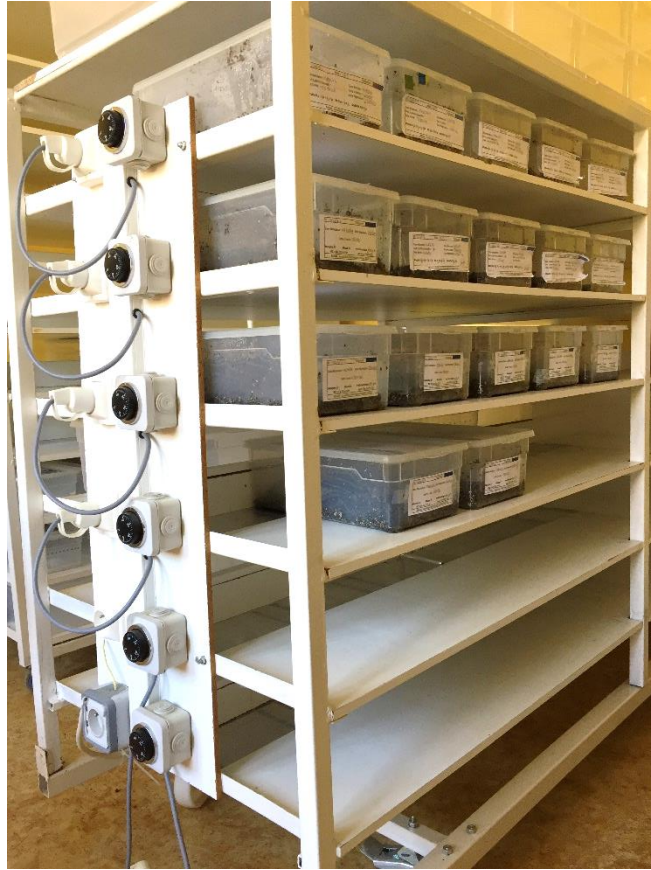
Figure 26. Photo d'un meuble d'élevage disposant d'un cordon chauffant à température réglable © L. Lange
