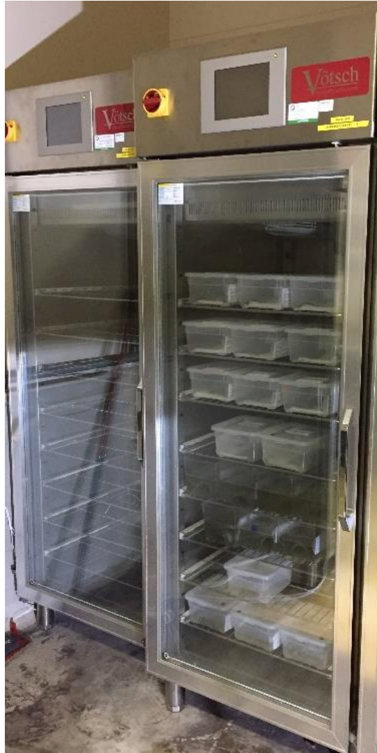
Figure 33. Enceinte climatique utilisée pour contrôler les conditions de développement des jeunes. © L. Lange
