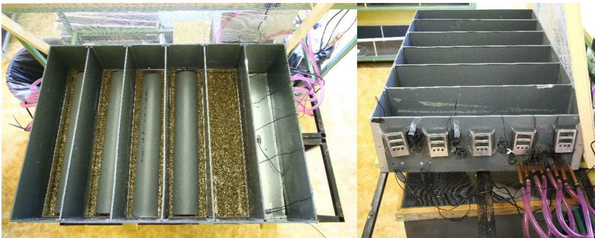
Figure 27. Photo du dispositif de gradient thermique. © M. Passerault
