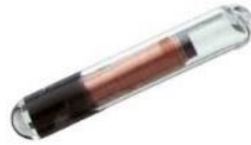
Figure 20. Photo d'un nano transpondeur utilisé pour le marquage individuel. © TROVAN
