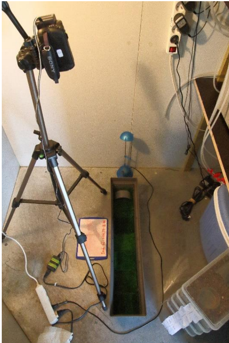
Figure 32. Photo illustrant le dispositif de mesure de la locomotion libre. © M. Passerault
