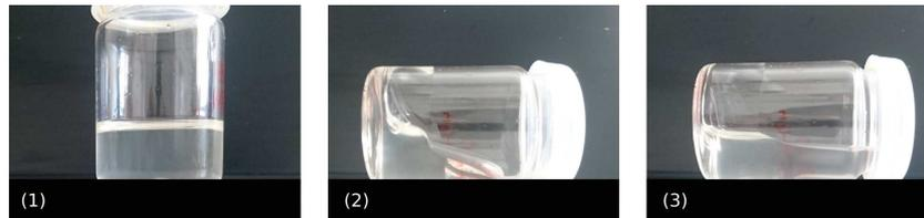
FIGURE 3.9 – Photos d'un échantillon de collodion après un temps de repos de 7 jours
