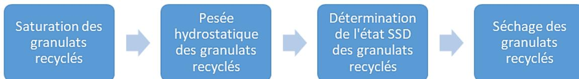
Figure 91 : Détermination de la porosité des granulats recyclés
