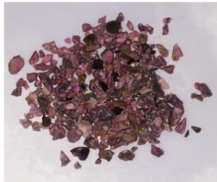
Figure 67 : Pulvérisation à la phénolphthaléine sur les granulats recyclés Longrines 1-4
