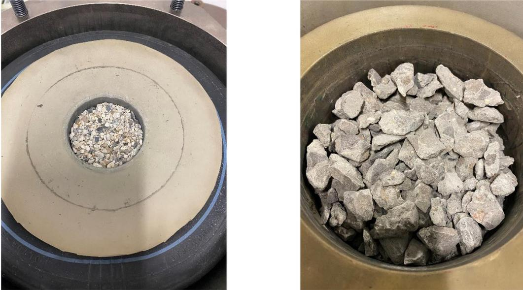
Figure 84 : Disposition des granulats recyclés dans la cellule
