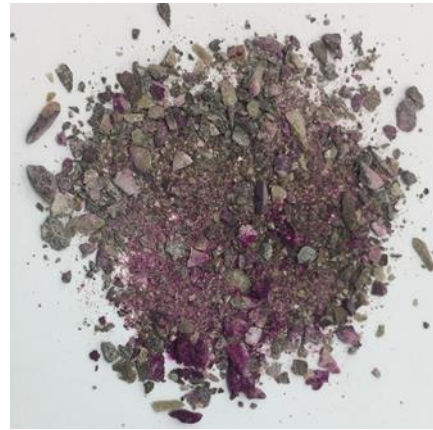
Figure 70 : Pulvérisation à la phénolphthaléine sur les granulats recyclés M75 1-4
