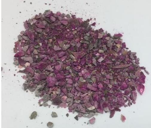
Figure 69 : Pulvérisation à la phénolphtaléine sur les granulats recyclés BO 1-4
