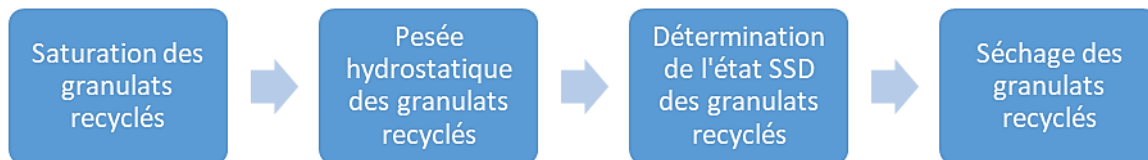
Figure 91 : Détermination de la porosité des granulats recyclés
