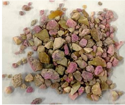
Figure 68 : Pulvérisation à la phénolphtaléine sur les granulats recyclés RCM 1-4
