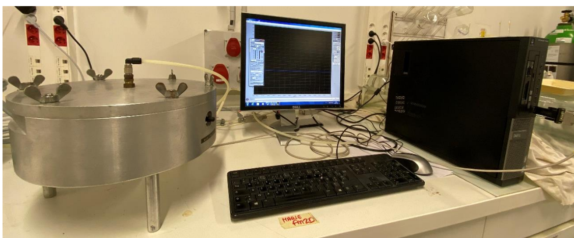
Figure 83 : Protocole dynamique de carbonatation accélérée
