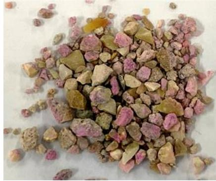
Figure 68 : Pulvérisation à la phénolphtaléine sur les granulats recyclés RCM 1-4
