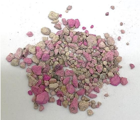
Figure 71 : Pulvérisation à la phénolphtaléine sur les granulats recyclés BPE 1-4
