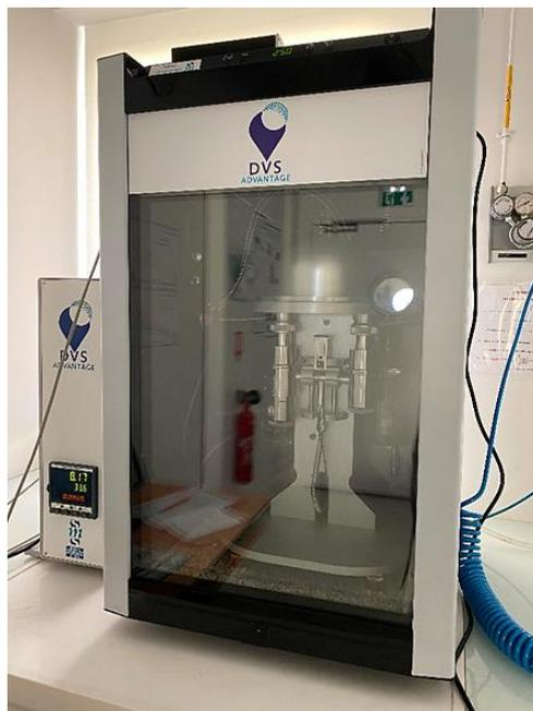
Figure 95 : Dispositif DVS au laboratoire
