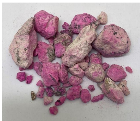
Figure 72 : Pulvérisation à la phénolphthaléine sur les granulats recyclés BPE 4-16
