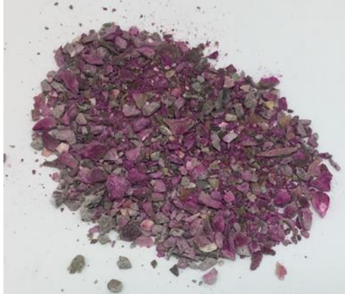
Figure 69 : Pulvérisation à la phénolphthaléine sur les granulats recyclés BO 1-4
