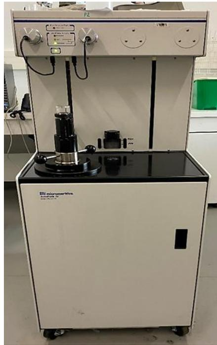
Figure 98 : Porosimètre à mercure
