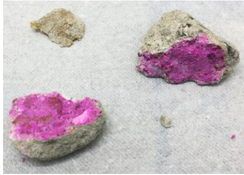
Figure 64 : Pulvérisation à la phénolphtaléine sur les granulats recyclés RB 10-20
