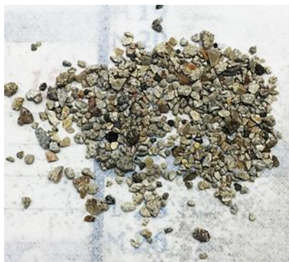
Figure 63 : Pulvérisation à la phénolphtaléine sur les granulats recyclés RB 1-4
