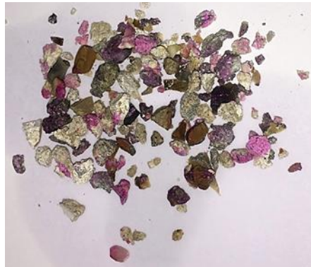
Figure 65 : Pulvérisation à la phénolphtaléine sur les granulats recyclés RB 1-4 C
