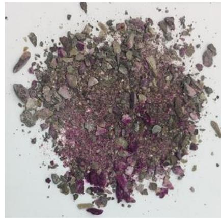
Figure 70 : Pulvérisation à la phénolphtaléine sur les granulats recyclés M75 1-4
