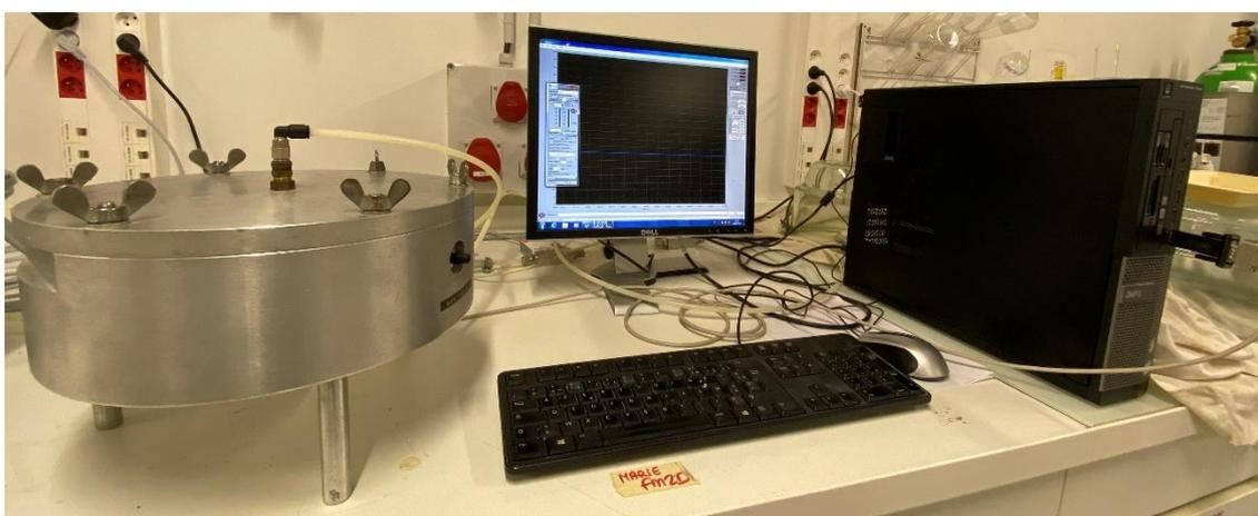
Figure 83 : Protocole dynamique de carbonatation accélérée
