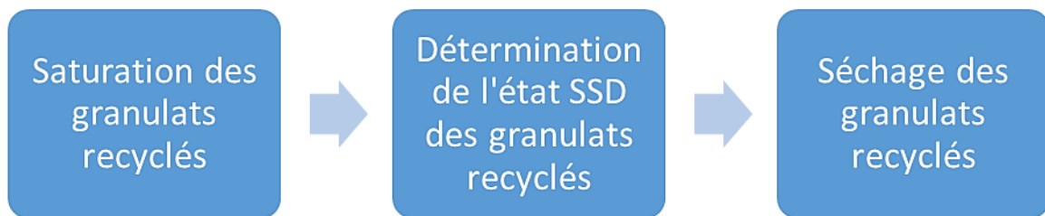
Figure 88 : Etapes de détermination du coefficient d'absorption des granulats recyclés
