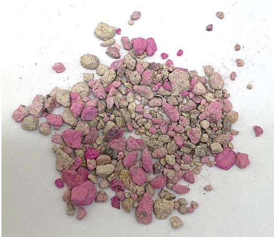
Figure 71 : Pulvérisation à la phénolphthaléine sur les granulats recyclés BPE 1-4
