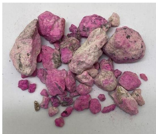
Figure 72 : Pulvérisation à la phénolphtaléine sur les granulats recyclés BPE 4-16
