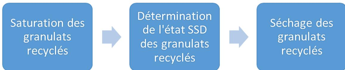
Figure 88 : Etapes de détermination du coefficient d'absorption des granulats recyclés
