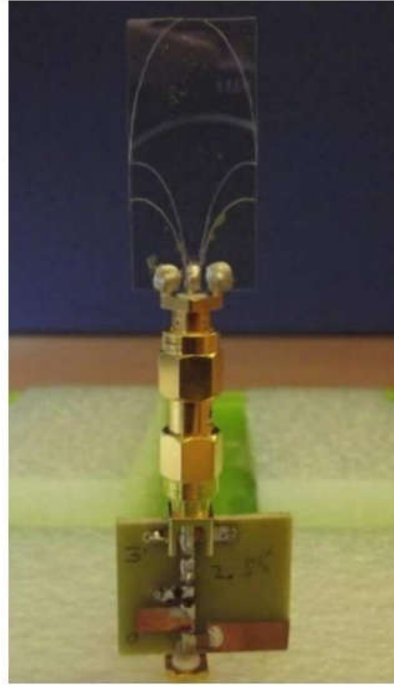
Figure 2-26 Photographie de la rectenna [24].
