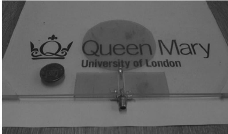
**Figure 2-23 Antenne ultra large bande optiquement transparente [21].**
