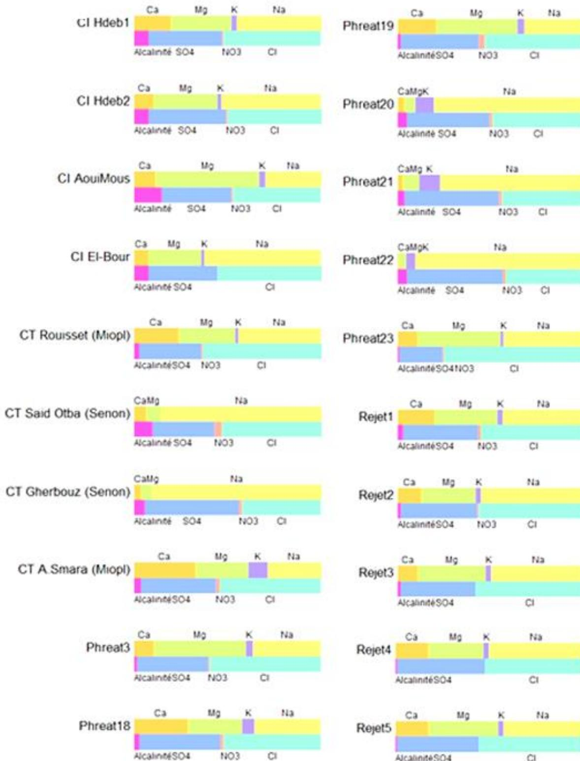
Figure 31 : Profil des eaux telluriques dans la région de Ouargla (Diagramme de Stabler)
