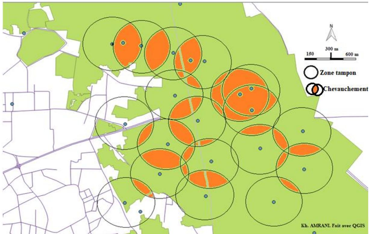
Figure 48 : Chevauchement des forages dans la palmeraie de Ouargla
