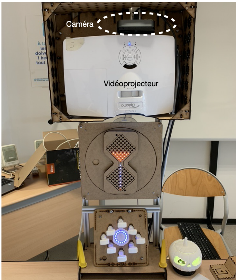
FIGURE 7.5 – Système de réalité augmentée spatiale composé d'un couple vidéo-projecteur/caméra. Le système de réalité augmentée est ici accompagné d'interfaces ambiantes et tangibles pour l'orchestration de classe et la gestion du temps.
