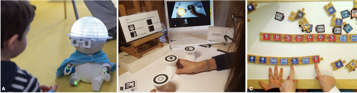
FIGURE 5.1 – 3 interfaces tangibles et/ou augmentées destinées à l'éducation. A) Teegi [71] une interface tangible pour aider les enfants à découvrir le fonctionnement du cerveau. B) Helios [66] une application de réalité augmentée see-through aidant les enfants à découvrir des notions complexes relatives à l'astronomie. C) The Robot Park , une interface tangible pour apprendre à programmer un robot grâce à des pièces en bois annotées.
