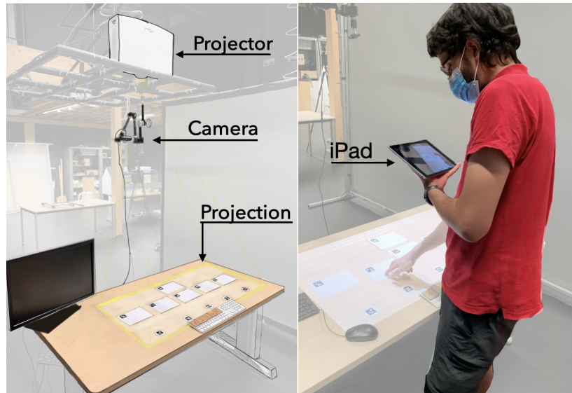
FIGURE 6.3 – Les deux configurations de RA utilisées pendant l'expérience. L'image de gauche montre la paire projecteur/caméra montée sur un pantographe. Sur l'image de droite, un sujet utilisant l'iPad et exécutant l'application de RA.
