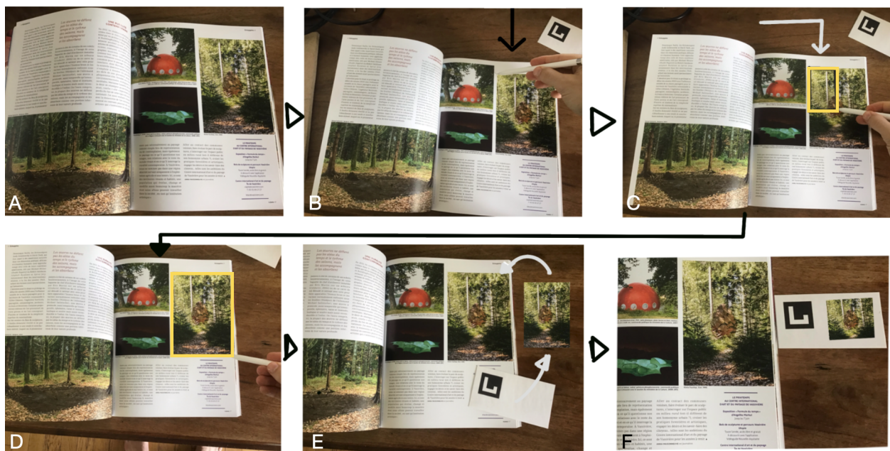
FIGURE 9.5 – Scénario d'utilisation pour numériser un contenu issu d'un livre. A) Le livre est déposé dans l'espace hybride. B) L'utilisateur peut sélectionner une image en positionnant le e-Beam sur le coin supérieur gauche. C) L'utilisateur effectue un glissé en diagonale pour ajuster le contenu à numériser. D) L'image est sélectionnée. E) Après le relâchement de la position, l'image est capturée et dupliquée à côté du livre. F) L'image dupliquée devient un média manipulable.
