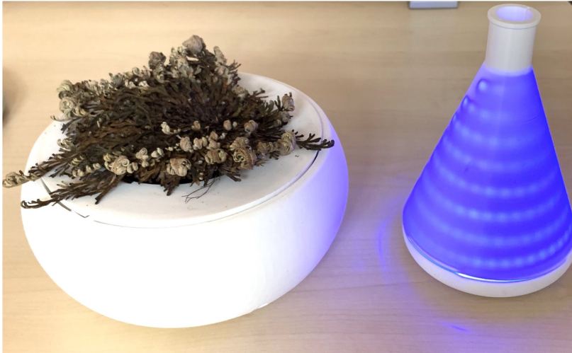
FIGURE 10.3 – Les deux interfaces tangibles développées dans le cadre du projet Erlen. Le pot connecté et la fiole prenant la forme d'un erlenmeyer. L'erlen est sur cette photo rempli à son maximum.
