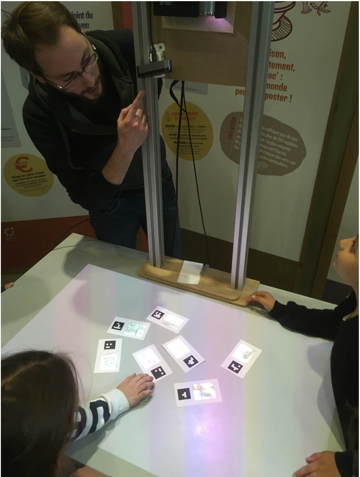
FIGURE 8.4 – La première itération de l’environnement augmenté composé désormais d’un espace unique d’interaction, où les médias virtuels sont physicalisés au sein de cartes papier.
