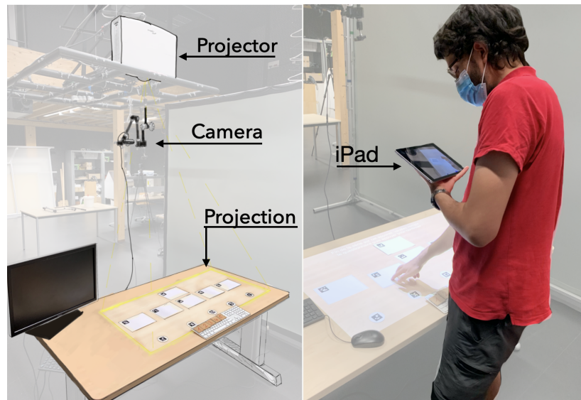
FIGURE 6.3 – Les deux configurations de RA utilisées pendant l'expérience. L'image de gauche montre la paire projecteur/caméra montée sur un pantographe. Sur l'image de droite, un sujet utilisant l'iPad et exécutant l'application de RA.
