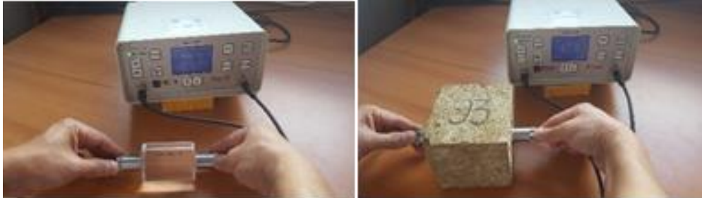
Figure 4.6 : Mesure de la vitesse d'impulsion ultrasonique (calibration et mesure) (Ngo, 2017)
