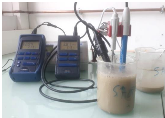
Figure 4.21 : Dispositif de mesure du pH et de la CE
