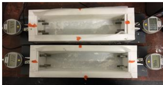
Figure 1.16 : Dispositif de mesure du retrait plastique longitudinal
