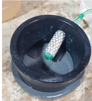
Figure 1.18 : Dispositif de mesure de la pression capillaire
