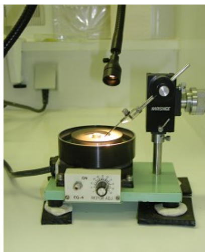
Figure E.9 : Photographie du montage de polissage d'une UME de carbone
