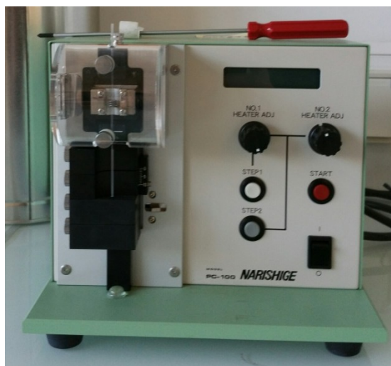
Figure E.6 : photographie de la micro-étireuse verticale. Le capillaire contenant la fibre de carbone est localisé en haut à gauche.
