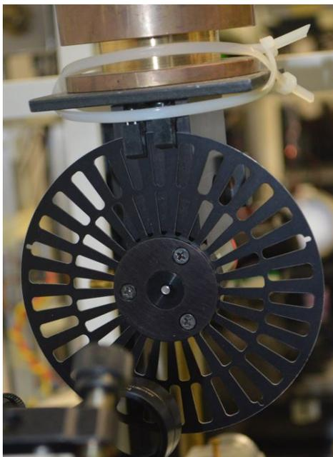
FIGURE 4.4 – Image du hacheur optique utilisé dans nos expériences : Nous utilisons les fentes extérieures pour la modulation du faisceau de pompe. Une masse métallique est placée au-dessus d'hacheur pour le stabiliser et limiter les vibrations parasites affectant les mesures.
