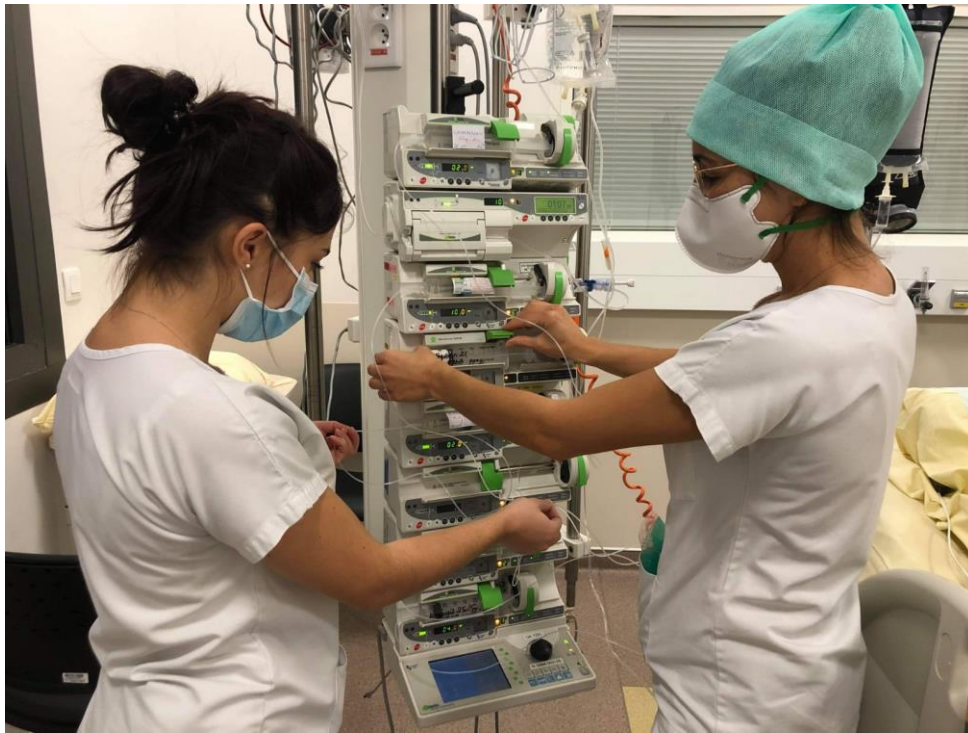
Figure 8 : Deux infirmières manipulant une seringue sur un PSE en service de réanimation/soins intensifs (Orchestra® module DPS – Fresenius Kabi)
