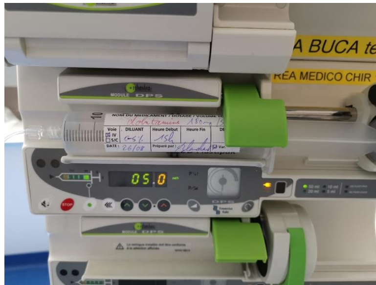
Figure 6 : Seringue de dobutamine installée sur un PSE (Orchestra® module DPS – Fresenius Kabi)
