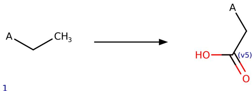
FIGURE 2.2 – **Exemple d’une réaction de carboxylation.** Représentation visuel d’une réaction de carboxylation d’un groupe éthyle, obtenue à l’aide de l’outil de visualisation MarvinView [11] à partir de la formule SMIRKS : [\* :1][CH2][CH3]>>[\* :1][CH2][CH](=[O])[OH]
