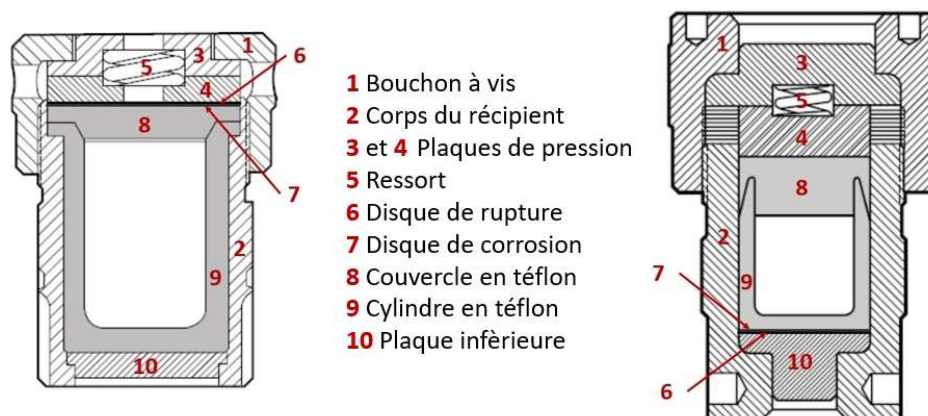
Figure A.9 : Schéma de la constitution des autoclaves utilisées [Parr®, 1997 ; Parr®, 2020]
