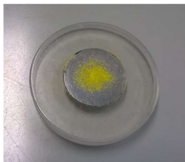
Figure A.11 : Photographie du porte échantillon de diffraction X par la poudre en silicium monocristallin sur lequel la poudre d'un composé est étalée.
