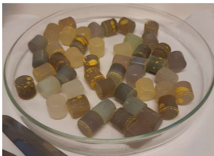
Figure A.7 : Photographie des cylindres en agate recouverts par la poudre (apparaissant agglomérée) après broyage
