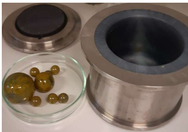
Figure A.8 : Photographie de la jarre du broyeur planétaire (à droite) et des billes en agate recouvertes par le produit après synthèse (à gauche)
