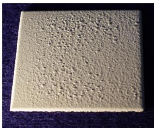
Figure 5.2 : État de surface d'un revêtement de mullite, obtenu pour une distance de convergence des jets de CO 2 de 300 mm, un diamètre de buse d_2 et une pression du CO 2 de 20 bars, après évacuation de l'agent porogène
