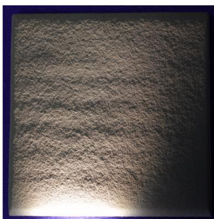
Figure 5.17 : Illustration de l'effet du pas de projection sur la réalisation de pièce épaisse. Exemple d'un revêtement de mullite à 70 % de porosité
