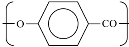
Figure 2.3 : Représentation chimique du poly(1,4-oxybenzoyl)
