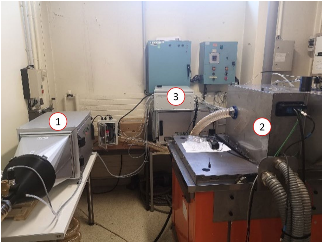
Figure 3. 6. a : Photographie du banc pion-disque adapté : (1) : Le premier caisson de filtration (2) : La chambre du pion-disque (3) Panneau de mesure regroupant les différents signaux électriques
