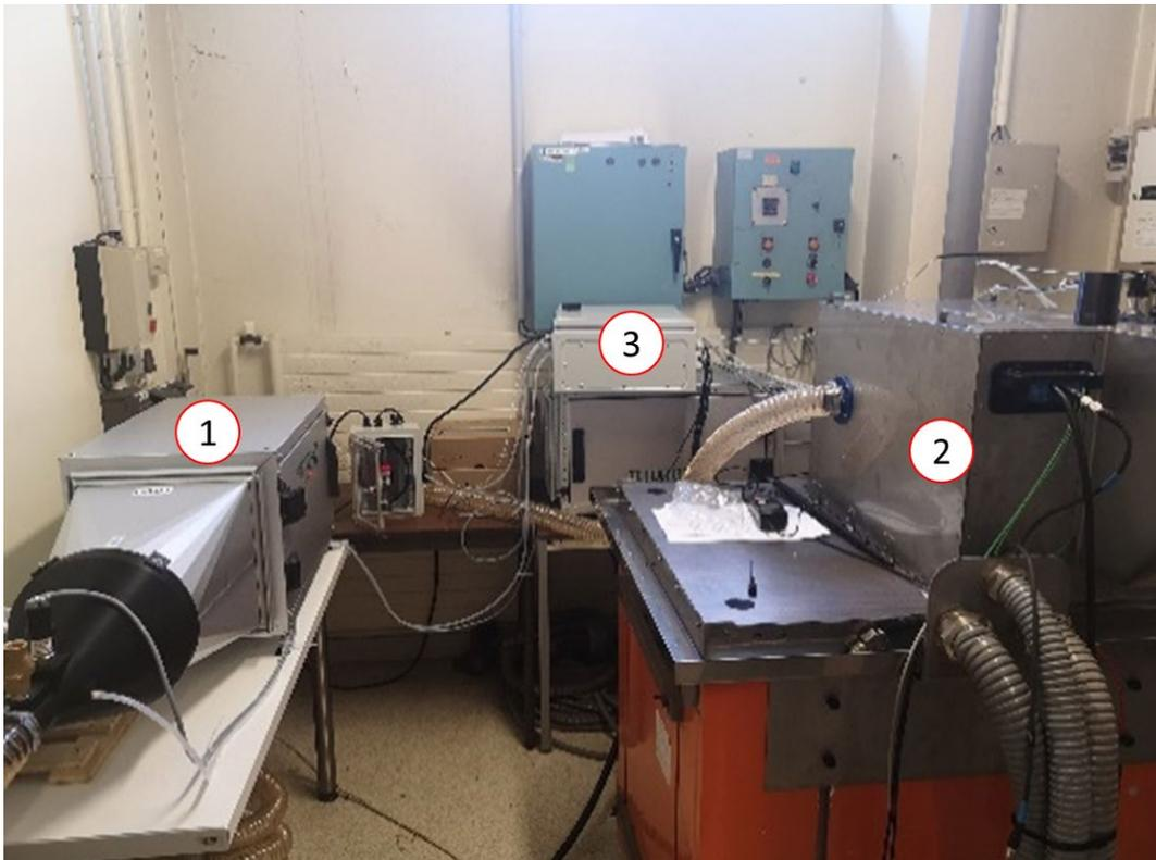
Figure 3. 6. a : Photographie du banc pion-disque adapté :
