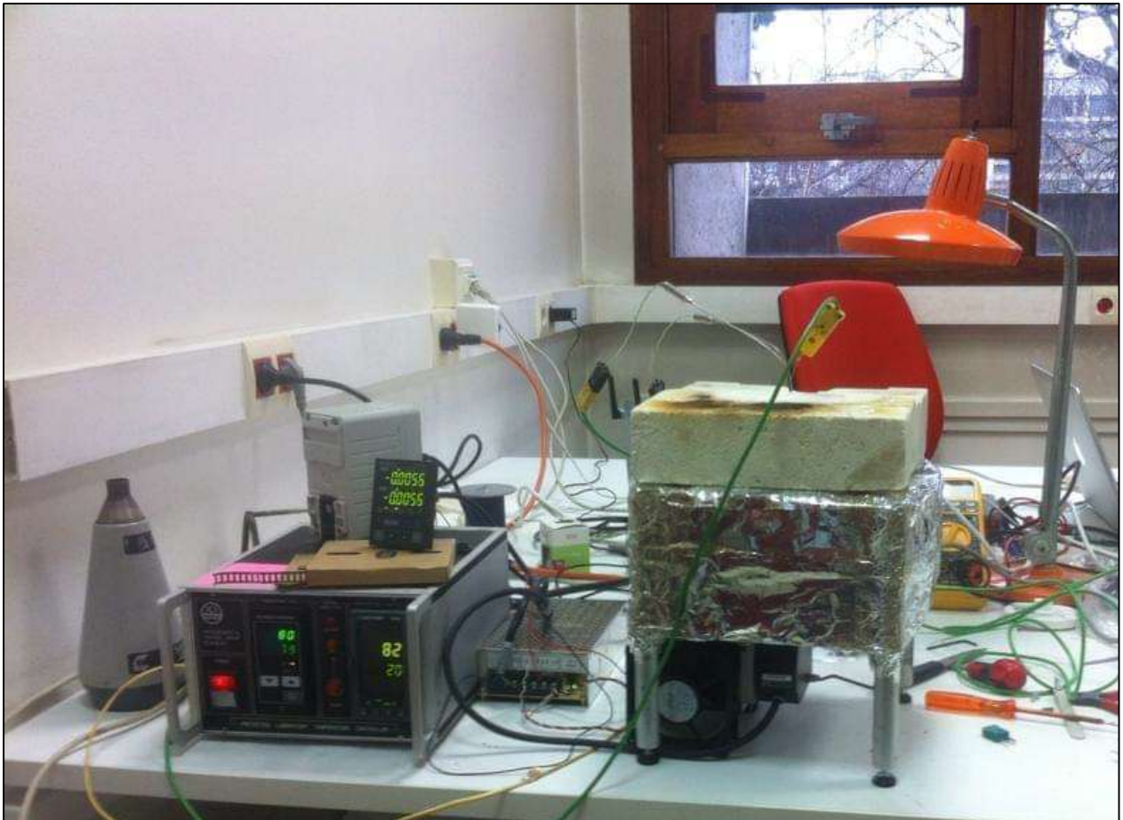
Figure 48 : Dilatomètre laser expérimental prêt à fonctionner. Il s'agit d'une version qui n'était pas encore équipée du refroidissement par eau mais d'un simple radiateur ventilé.
