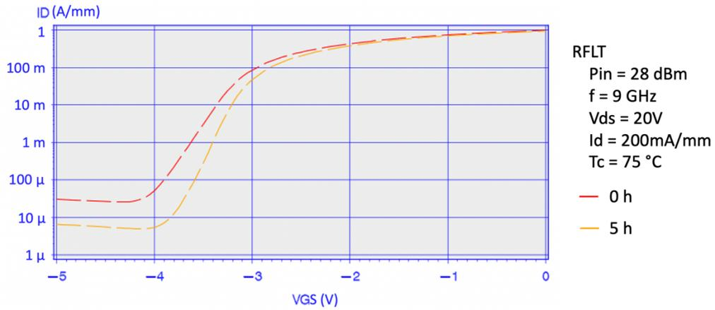
Figure 4.1-2 : Caractéristique de transfert avant (en rouge) et après 5 h (en jaune) de test RFLT (Vds = 20 V, Id = 200 mA/mm et Pin = 28 dBm à Tc = 75 °C) à 9 GHz
