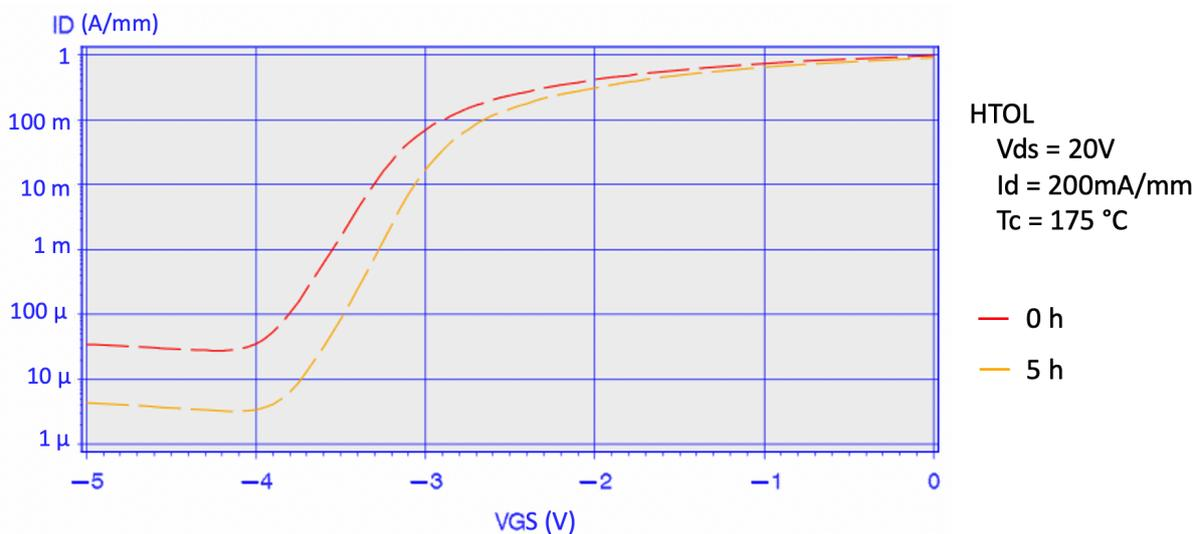
Figure 4.1-1 : Caractéristique de transfert avant (en rouge) et après 5 h (en jaune) de test HTOL ( $V_{ds} = 20$  V &  $I_d = 200$  mA/mm à  $175$  °C)
