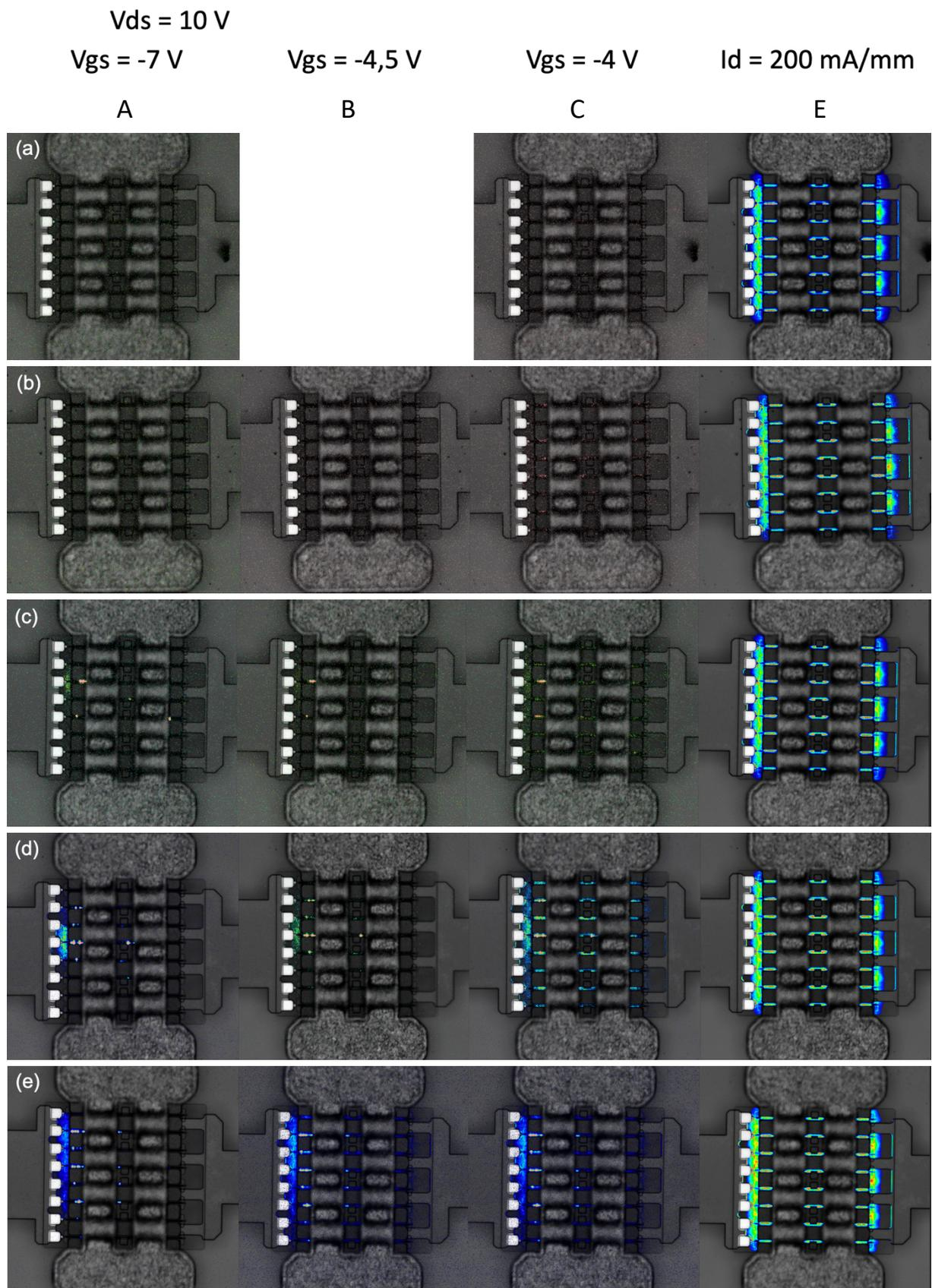
Figure 4.5-2 : Mesures EMMI pour un composant de référence (a) et l'ensemble des composants vieillis en commençant par celui avec le moins de courant de fuite (b) jusqu'à celui avec le plus de courant de fuite (e) pour les conditions  $V_{gs} = -7\text{ V}$ ,  $V_{gs} = -4,5\text{ V}$ ,  $V_{gs} = -4\text{ V}$  et  $V_{gs}$  pour  $I_d = 200\text{ mA/mm}$  de gauche à droite
