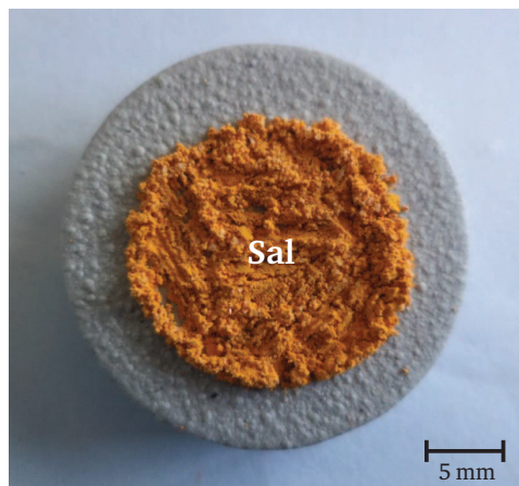
Figura 2.15. Disposición de la mezcla de sal corrosiva sobre la superficie del recubrimiento
