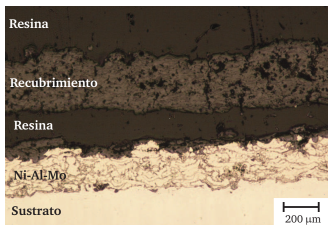
Figura 4.28. Micrografía de la falla del recubrimiento de \text{Al}_2\text{O}_3 - 40% \text{ZrO}_2 después de la oxidación isotérmica
