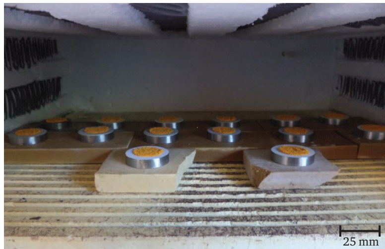
Figura 2.16. Muestras con la mezcla corrosiva en el horno antes del ensayo de corrosión en caliente
