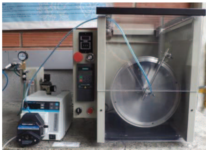
Figura 4.9. Sistema de aglomeración de polvos [134]
