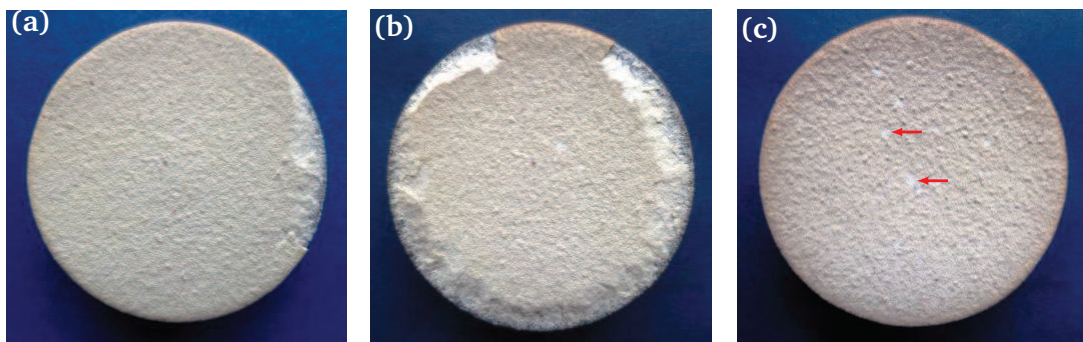
Figura 5.21. Falla en la superficie del recubrimiento de (a) CSZ L después del choque térmico N° 116 y (b) 400; (c) Recubrimiento CSZ H después del choque térmico N° 400
