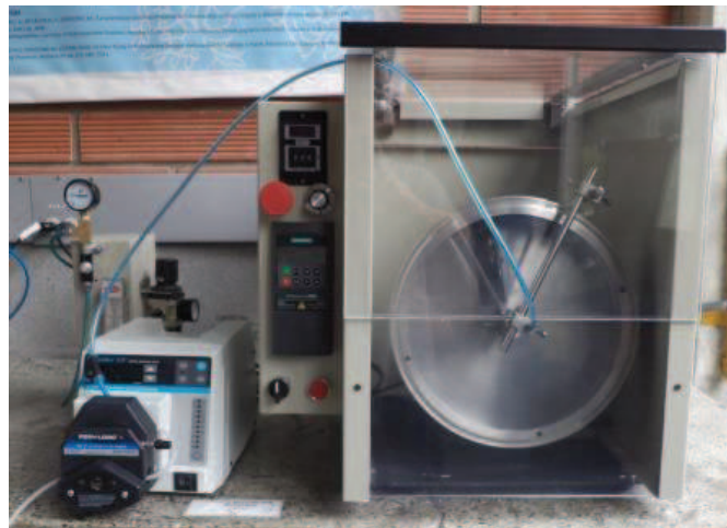
Figura 4.9. Sistema de aglomeración de polvos [134]
