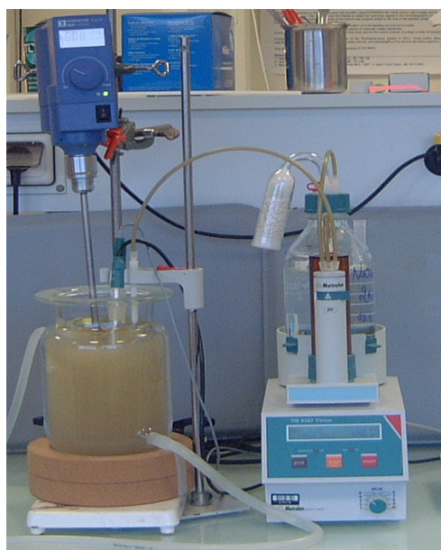
Figure 42. Dispositif expérimental pour la réaction d'hydrolyse enzymatique: réacteur enzymatique thermostaté couplé au pH-Stat.
