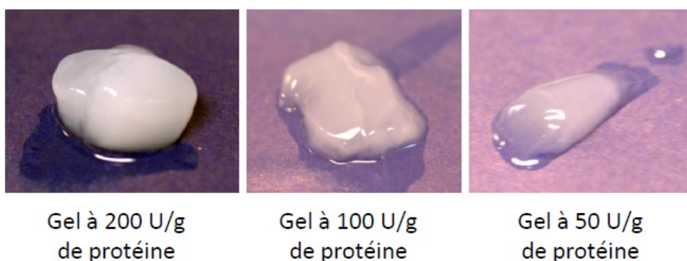
Figure 73. Hydrogels obtenus lors des essais préliminaires de réticulation du collagène par la mTG avec les différentes concentrations en enzymes testées (200, 100 et 50 U/g de protéine).
