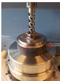
Figure 53. Mesure des modules viscoélastiques du collagène réticulé sur l'appareil Gemini.
