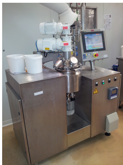
Figure 35. Réacteur (VMI, réacteur basculant 10L) de la société SPF-DIANA dans lequel a été réalisé l'extraction de collagène pour des quantités allant jusqu'à 1,5kg.
