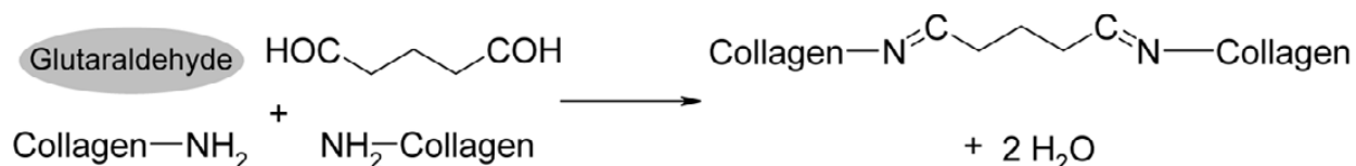
Figure 23. Réaction de réticulation du collagène par le GTA.
