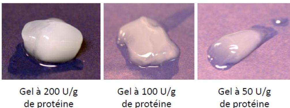
Figure 73. Hydrogels obtenus lors des essais préliminaires de réticulation du collagène par la mTG avec les différentes concentrations en enzymes testées (200, 100 et 50 U/g de protéine).
