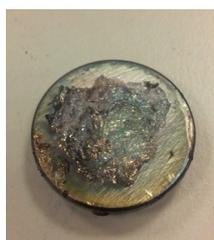
Figure 52. Échantillon de collagène métallisé et monté sur support avant d'être observé en MEB.
