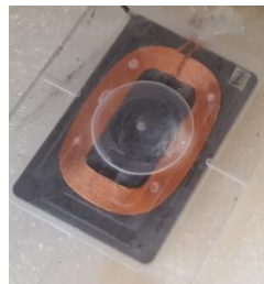
Figure III.58 Prototype d'antenne réceptrice utilisée par le TPR1A
