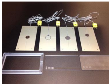
Figure IV.24 Exemple de sets d'OME certifiés Qi et utilisés pour la qualification des systèmes d'émission
