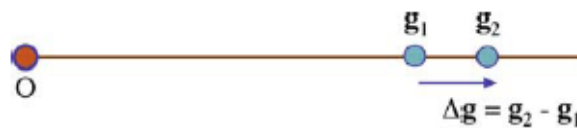
Figure 7: Relation entre franges de Moiré de translation des plans 1, 2 et leurs vecteurs réciproques, de (Williams et Carter 1996).
