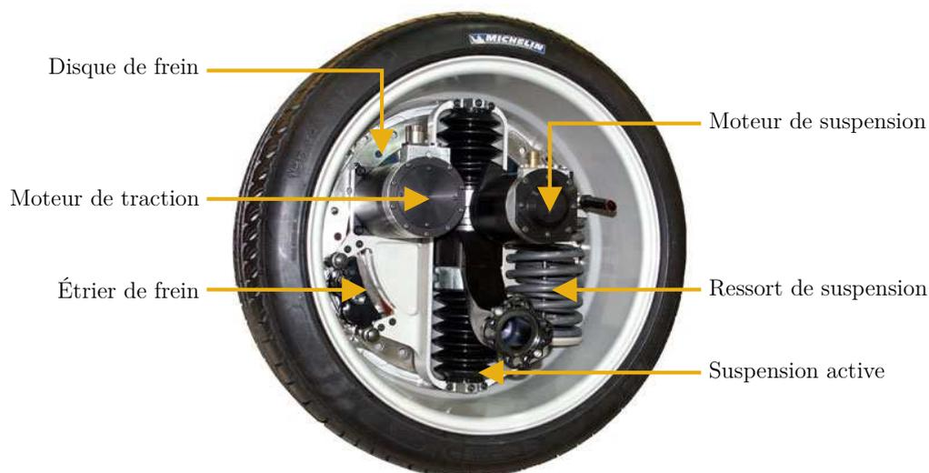
FIGURE 1.13 – Exemple de moteur roue : l'Active Wheel de Michelin
