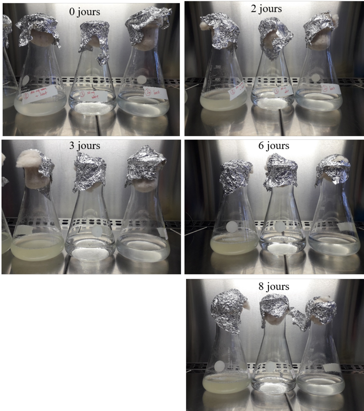
FIGURE 5.2 – Évolution de l'aspect des milieux de culture au cours du temps pendant l'expérience d'altération de VNM. En photo de gauche à droite : condition avec 100 mg VNM + P. putida , contrôle verre VNM 100 mg, contrôle P. putida .
