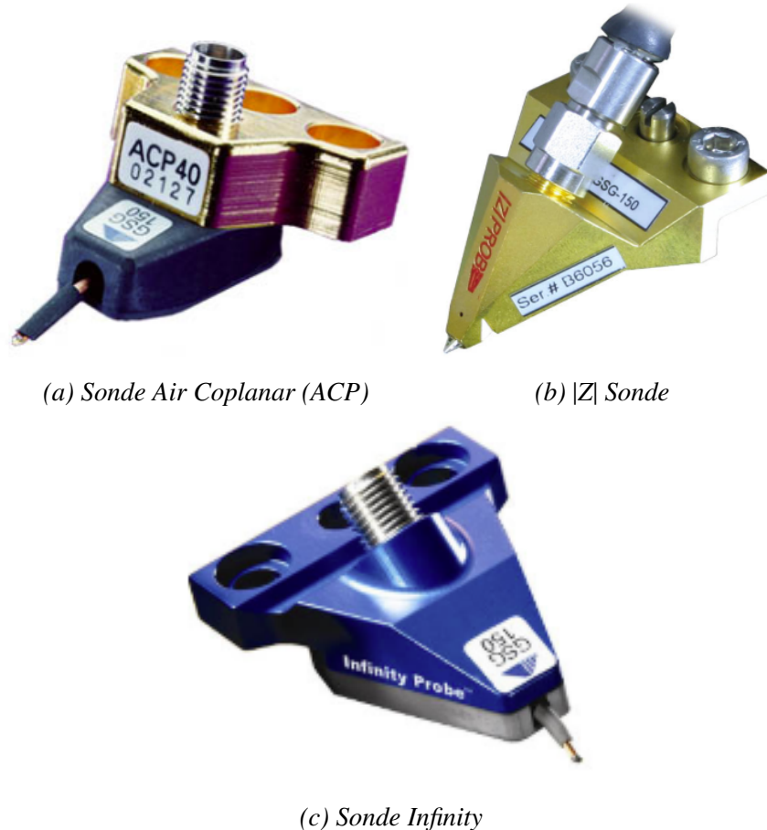
Figure 4.3 – Différents types de sondes RF
