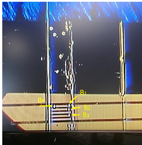
Figure 5.36 – Photographie de quatre billes de polystyrène piégée dans la zone de détection. Le biocapteur CPW-IDT est utilisé pour la mesure sous-pointes.
