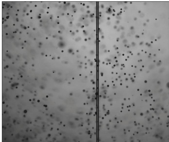
Figure 146 : Utilisation d'un fil de pêche comme "piège à bulles"
