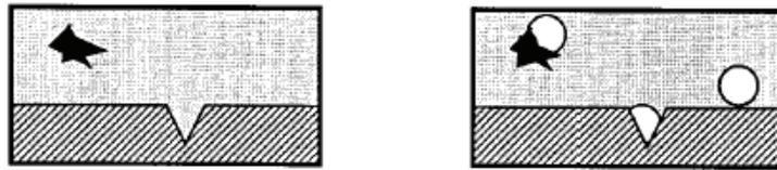
Figure 5 : Nucléation classique de type II avant et après sursaturation [Jon99]
