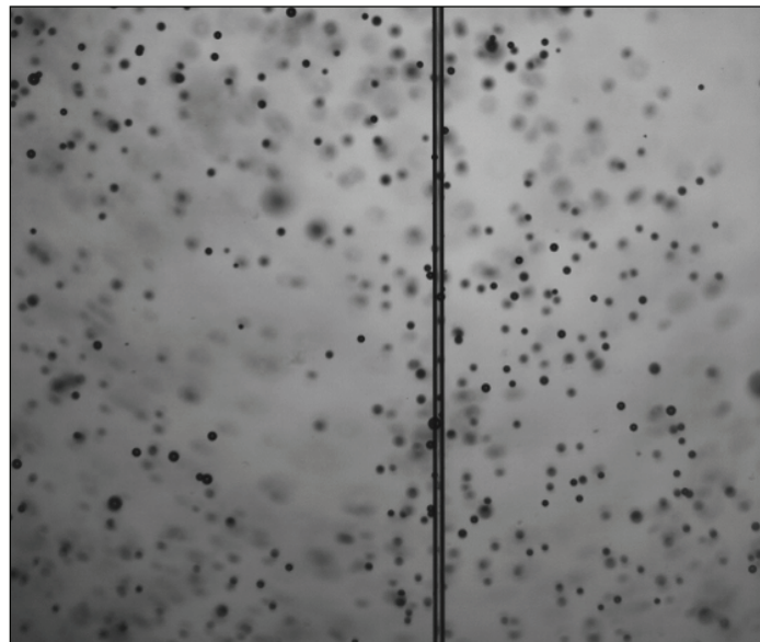
Figure 146 : Utilisation d'un fil de pêche comme "piège à bulles"
