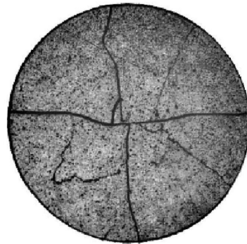
FIGURE 1.7 – Céramographie d'une pastille REP fissurée par le gradient thermique, après un cycle d'irradiation - plan transversal de la pastille.
