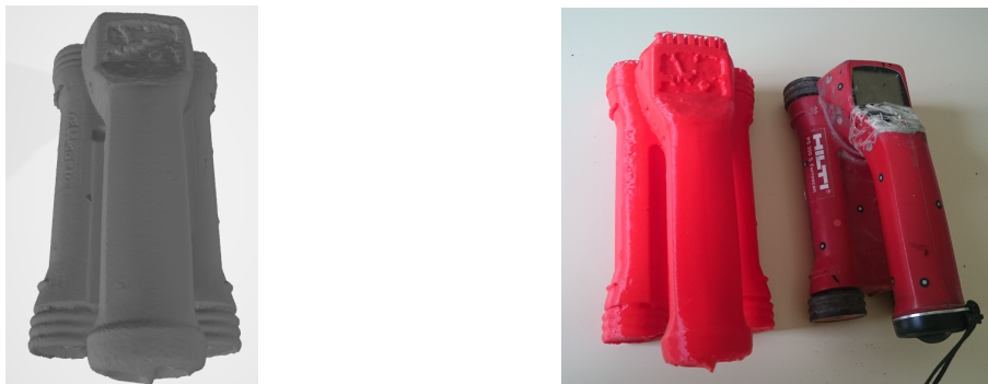
FIGURE 5.12 – Modélisation CAO, reproduction et véritable ferroskan
