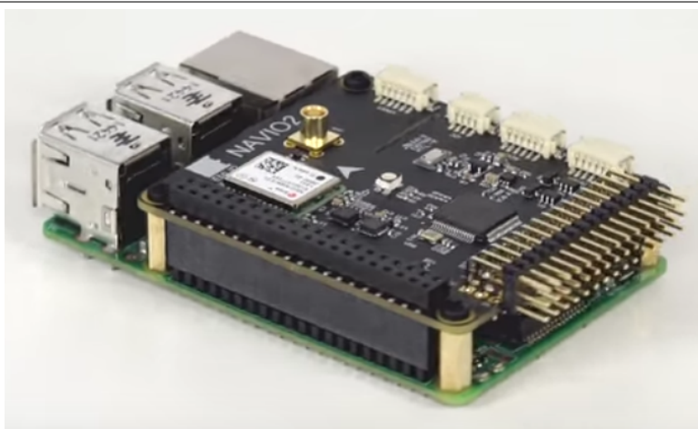
FIGURE 5.36 – Raspberry pi équipé d'un Navio 2
