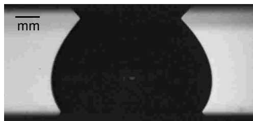
Figure I.25 : Image de la goutte de plomb dès la formation du pont liquide sur les substrats M2T30_38
