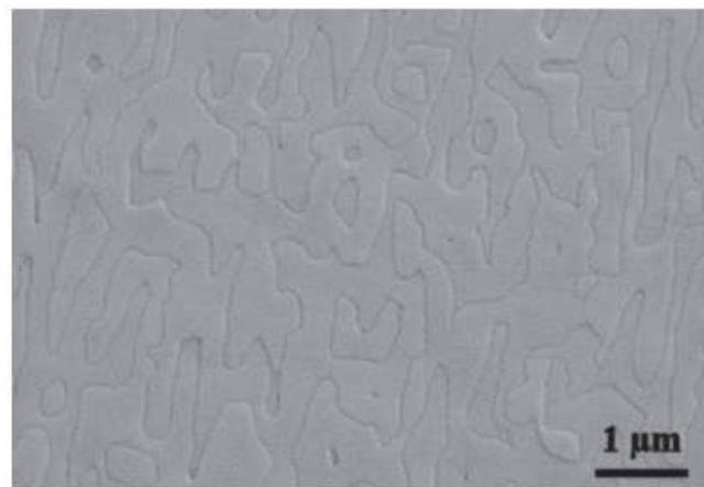
Figure 28 : Présence des parois d'antiphase à la surface d'une couche GaAs/Si présentée sous forme d'une image MEB
