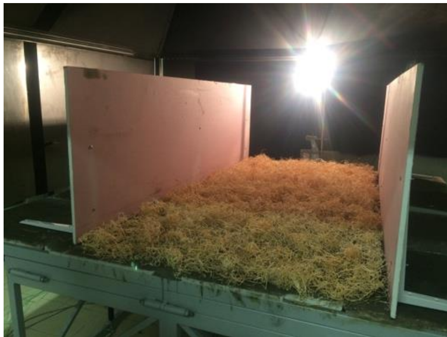
Figure 3.1 Distribution du combustible sur la table de combustion d'une manière homogène.
