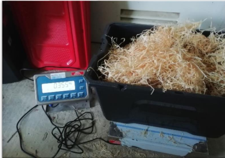
Figure 3.2 Pesage de la quantité nécessaire de la frisure de bois à 13,2 % d'humidité.
