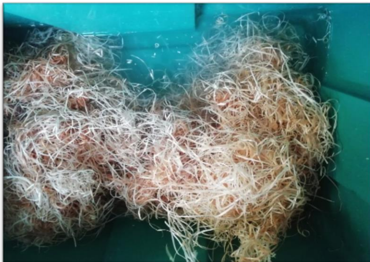
Figure 3.3 L'immersion totale de la frisure de bois dans l'eau
