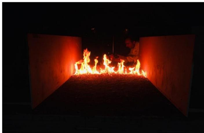
Figure 3.6 Front de la flamme vertical obtenu pour un test de brûlage d'un lit de frisure de bois caractérisé par une charge de  $0,2 \text{ kg m}^{-2}$ .
