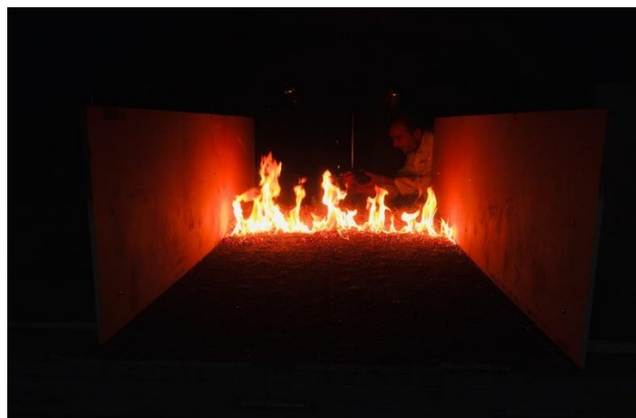
Figure 3.6 Front de la flamme vertical obtenu pour un test de brûlage d'un lit de frisure de bois caractérisé par une charge de 0,2 \text{ kg m}^{-2} .
