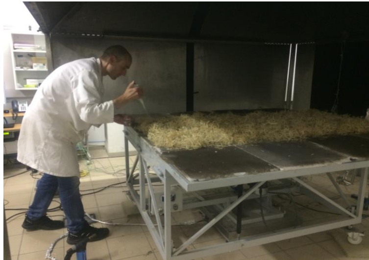
Figure 3.8 Conception de la ligne d'allumage à l'aide du méthanol versé sur les premiers 5 cm du combustible.
