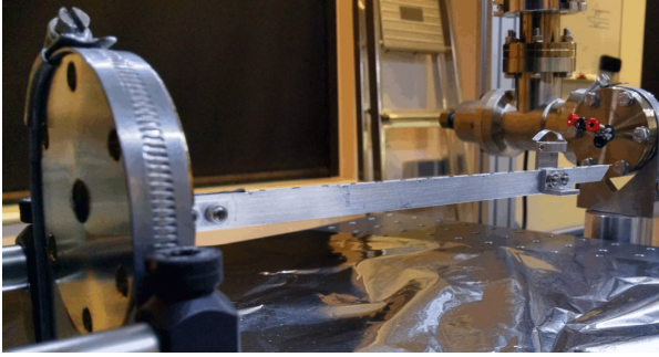
FIGURE 1.2. – Photographie du rail en aluminium qui supporte la fibre multimode, avant d'être mis sous vide. La pièce au bout du rail s'insère dans la bride en titane et assure la stabilité mécanique.
