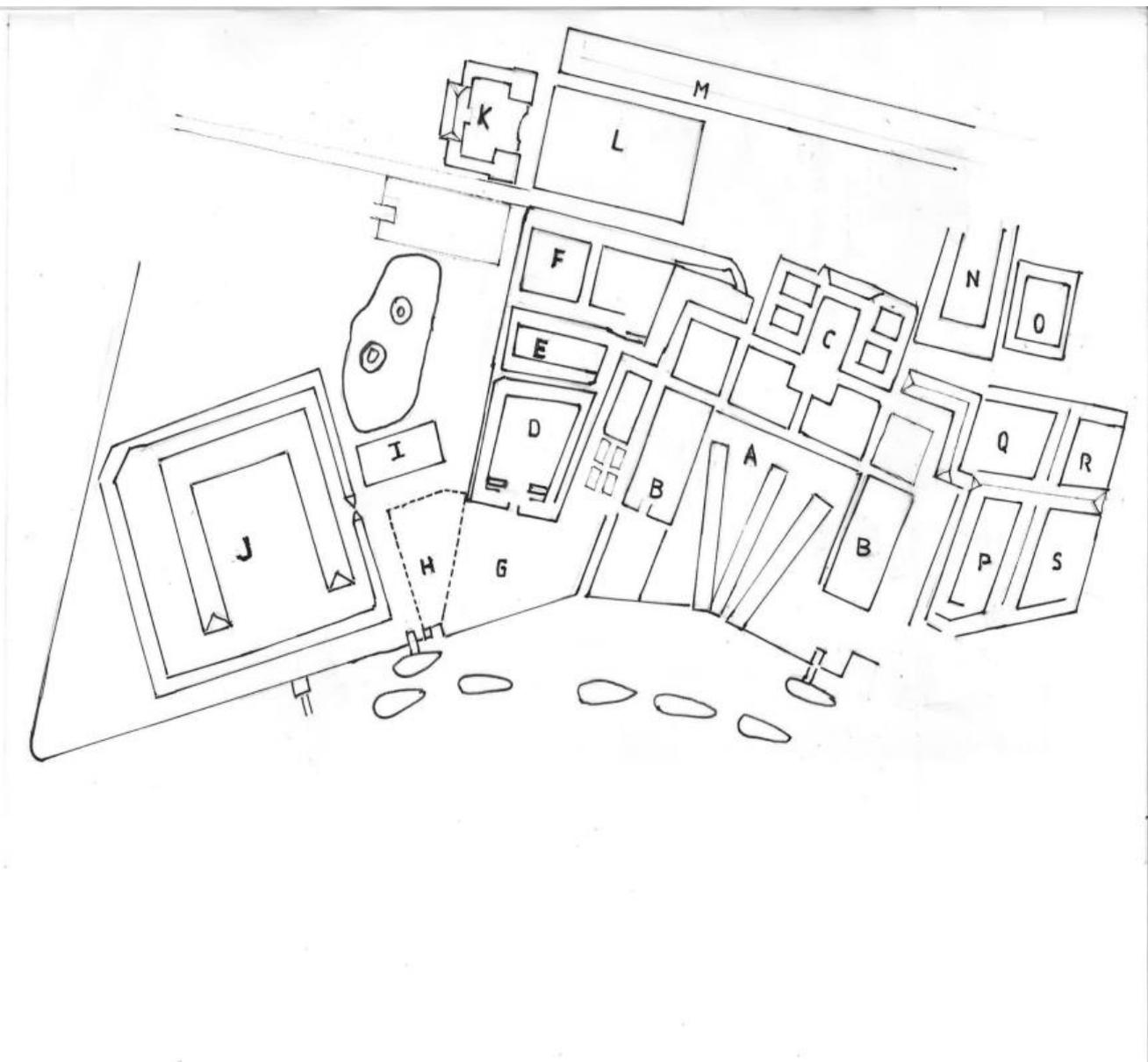
A- Cales pour les vaisseaux B- Chantiers des constructions C- Hôtel du Port D- Magasin de désarmement E- Cour des Ateliers F- Tonnellerie G- Dépôt des ancres H- Parc d'artillerie I- Employés des ventes J- Magasin des ventes K- Hôtel des ventes L- Place d'arme M- Corderie N- Logements employés du port O- Forges P- Magasin général Q- Magasin des vivres R- Cour des salaisons S- Cour des fers
