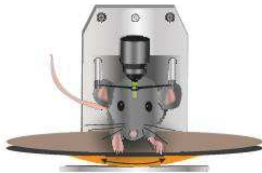
Figure 16 : Schéma du système d'imagerie en configuration « tête-fixée ».
