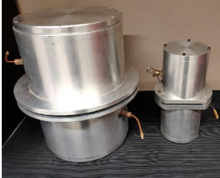
Figure 18 : Cavités résonantes utilisées dans la caractérisation du kapton
