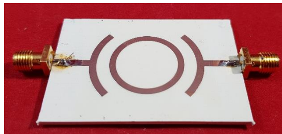
Figure 58 : Anneau de caractérisation en RO4360G2
